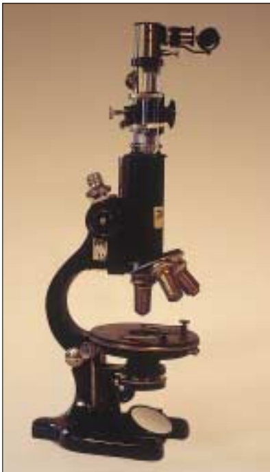
Foto 19 - Microscopio ottico, con spettrometro a due viste appaiate.
