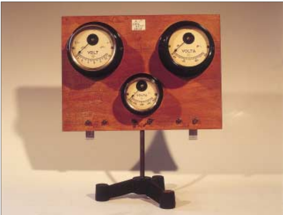
Foto 17 - Voltmetri: da 15, 80 e 400 volt di fondo scala.
