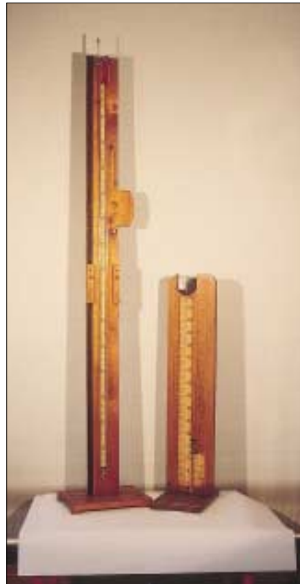
Foto 5 - Apparecchio per verifica della legge di Boyle (secondo Mueller), con termometro ad aria.
