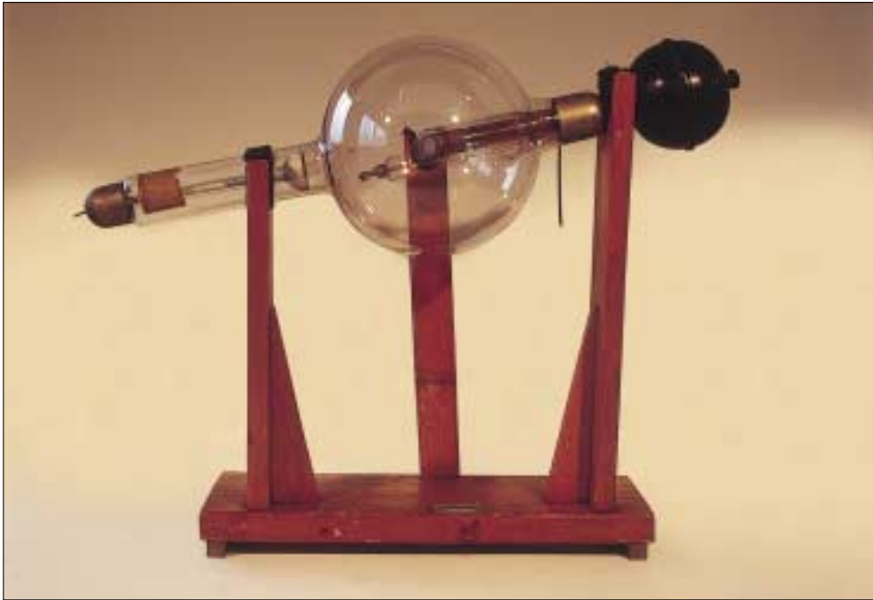
Foto 12 - Tubo per raggi X, con boccia di raffreddamento.
