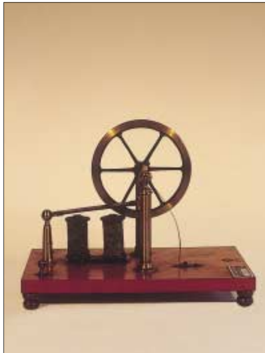
Foto 20 - Motorino con elettromagnete a U, e volano.
